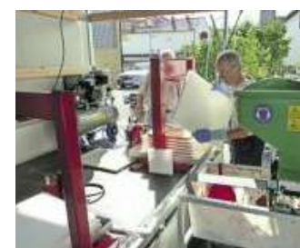
Arbeiten mit Hochdruck: Mehrere Lagen zerkleinerter Früchte, die durch Kunststoffplatten getrennt sind, werden gleichzeitig gepresst.
